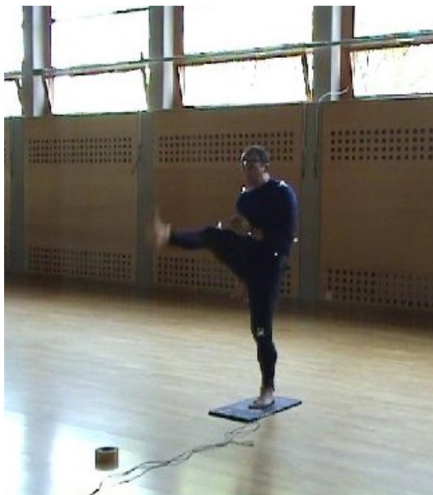
Obr. 106 Využití měřicí tlakové plošiny při analýze distribuce tlaku v chodidle během kopu
