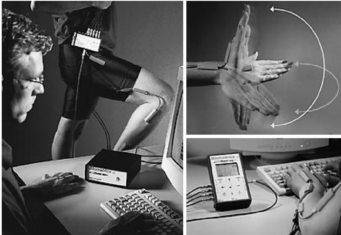
Obr. 95 Ukázka elektrogoniometru a jeho využití při měření změn úhlu v kloubu (Biometrics Ltd, 2010)
