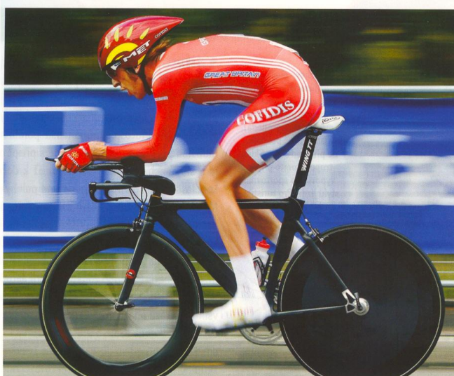
Maximální výkon. Sedlo je na speciálu posunuté dopředu a závodník pozici dovádí k „dokonalosti“ sezením na jeho špičce. Nástavce ještě zvyšují aerodynamiku, která bývá při těchto rychlostech rozhodující.
