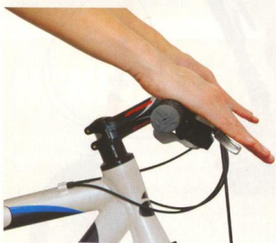
Správné nastavení pák. Stačí ohnout prsty a brzdíme. Jak dokáží brzdy pohotově a ergonomicky ovládat ti, kteří mají brzdové páky vodorovně nebo dokonce vzhůru, je nám záhadou.
