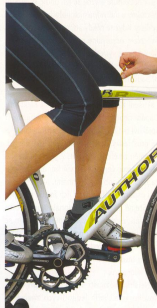
Doporučení o svislici spuštěné ze špičky kolene se liší. Setkáte se s názorem, že má procházet osou pedálu, ale také s tvrzením, že se má dotýkat až konce kliky. Předozadní polohu sedla tedy nastavte někde v tomto rozsahu.
