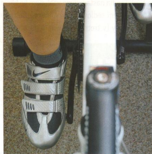
Nejčastější nastavení zarážek. Osa chodidla je rovnoběžná nebo téměř rovnoběžná s osou kola. Naopak odřené nápisy na klikách napovídají, že je něco v nepořádku.
