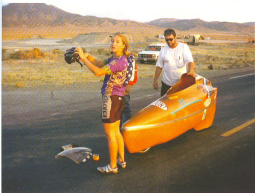
HPV neboli human powered vehicles – jejich velká přednost tkví v malém aerodynamickém odporu. Jsou-li kapotovány, lze se v nich při stejné námaze pohybovat mnohem větší rychlostí než na běžném kole.
