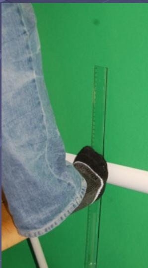
TO sedí čelem ke stěně a padající ploché měřítko zachycuje přitisknutím špičkou ke stěně, opakujeme 20x
