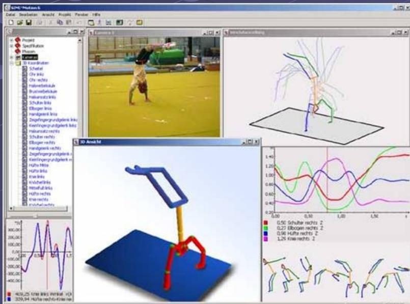
Zařízení schopné digitalizovat záznam pohybu pomocí reflexních bodů umístěných na těle TO.
