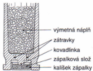
Středový zápal se zápalkou typu Berdan
