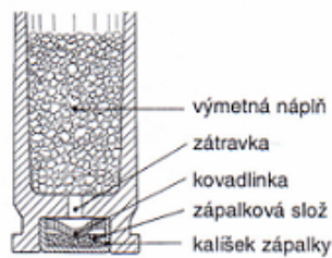
Středový zápal se zápalkou typu Boxer
