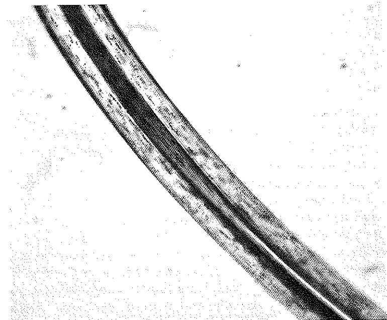
Obr. 9.5: Vzhled dutého polyesterového vlákna pod mikroskopem (autor Ing. Ladislav Zíka).
