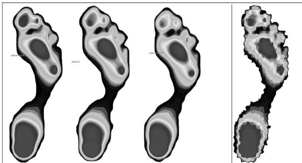
Obr. 111 Tři naměřené tlakové obrazy a jejich průměr
