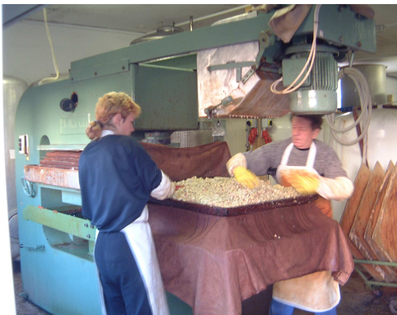
Obr. 2: Lisování na dvoupolohovém hydraulickém plachetkovém lisu
