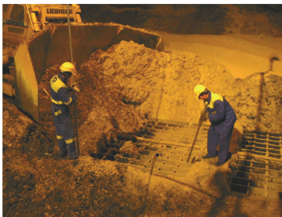
„Protlačování“ rozměrnější štěpky štěrbinami nad dopravníkem
