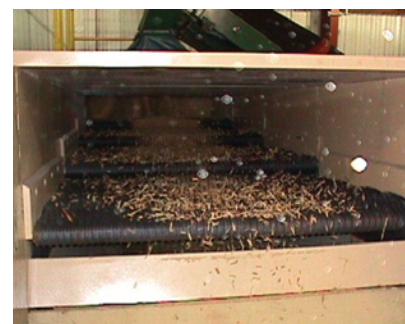
Zařízení na Willows Islands pro společné spalování pilin a uhlí. Nahoře silo s biopalivem, dole drcení biopaliva. (zdroj Foster and Wheeler)
