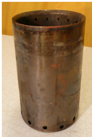
Obr. 12 – Sací otvory ve vnějším plášti
