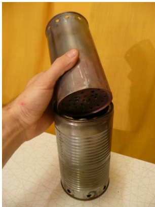
Obr. 7 – Spojení vnější a vnitřní plechovky
