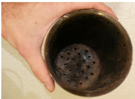
Obr. 13 – Otvory ve vnitřním plášti
