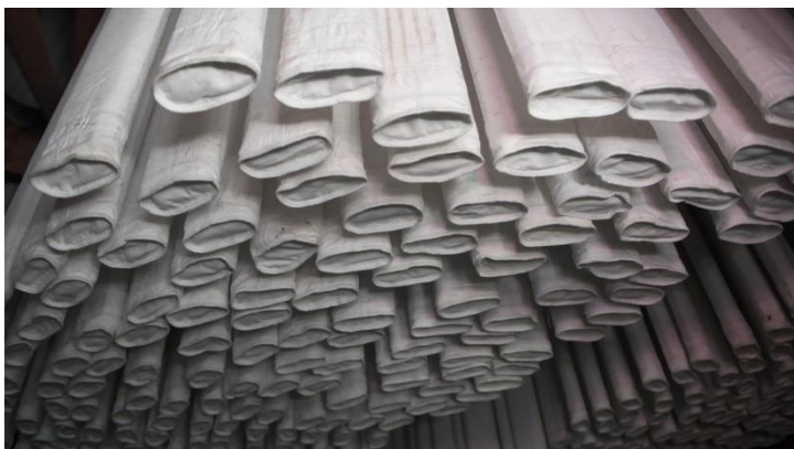
30 Látkové hadice z mikrovláken na zachycení prachu v elektrárně Chvaletice (Zdroj: oenergetice.cz)
