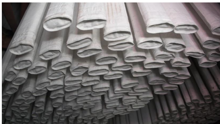
33 Látkové hadice z mikrovláken na zachycení prachu v elektrárně Chvaletice (Zdroj: oenergetice.cz)
