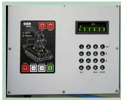
Ovládací a kontrolní panel pro rozvinutí antén radiolokátorů
