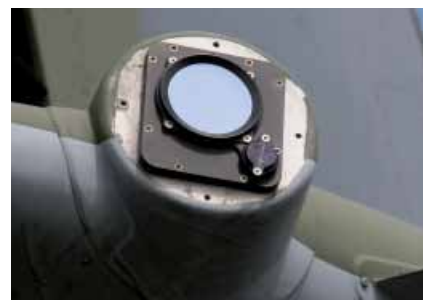
SENZOR VAROVNÉHO SYSTÉMU PROTI RAKETÁM
