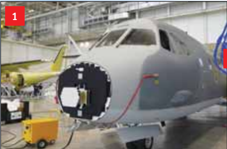
CASA C-295M se sejmutým příďovým radomem a odkrytou anténou meteorologického radaru. Letoun vzadu bez ochranného nátěru je ještě ve žlutavé barvě kompozitových panelů pokrývajících konstrukci draku.
