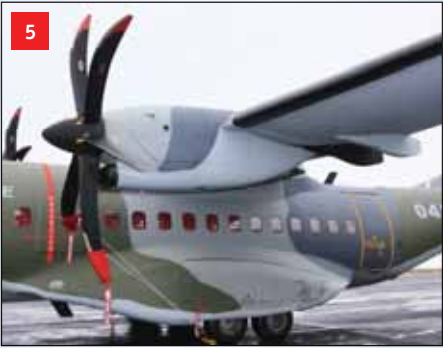
Motorová gondola se šestilistou vrtulí na náběžné hraně křídla a kryty táhel klapek na odtokové hraně. Součástí draku spodní části trupu je aerodynamická gondola hlavního podvozku s reflektory vpředu dole.
