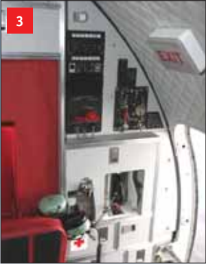
Panel pro ovládání sklápění dveří, zadní rampy a zařízení pro transport nákladu
