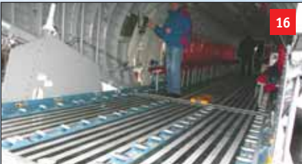
Záďová rampa se čtyřmi vedeními osazenými segmenty válečkové dráhy. Vlevo je umístěné mohutné šedé svodidlo chránící hydraulický válec při vysazování nákladu a stabilizující obtékání.
