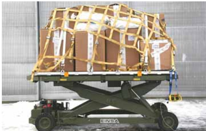
Teleskopická nakládací plošina umožňuje zdvihání nákladu a jeho přesun na rampu C-295M zdviženou do roviny.
