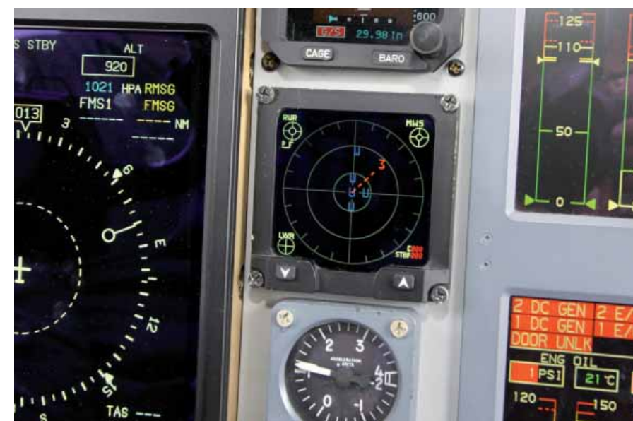
DISPLEJ UMÍSTĚNÝ V PILOTNÍ KABINĚ K ZOBRAZENÍ MOŽNÝCH HROZB OD SYSTÉMU DAS (RWR,MWS,LWS), JAKOŽ I INDIKACE AKTUÁLNÍHO MNOŽSTVÍ KLAMNÝCH CÍLŮ VE VÝMETNICÍCH
