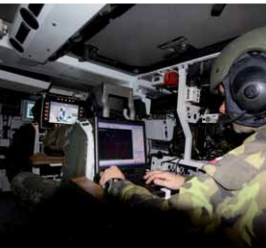
POHLED DO VNITŘKU KBV-PZLOK. NEJBLÍŽE JE OPERÁTOR RL, PŘED NĚM PAK OPERÁTOR ELEKTROOPTICKÝCH SYSTÉMŮ UMÍSTĚNÝCH NA VÝSUVNÉ SENZORICKÉ HLAVĚ. ZCELA VPŘEDU JE VIDĚT OBRAZOVKA STŘELCE (VPRAVO) A OBRAZOVKA VELITELE.
