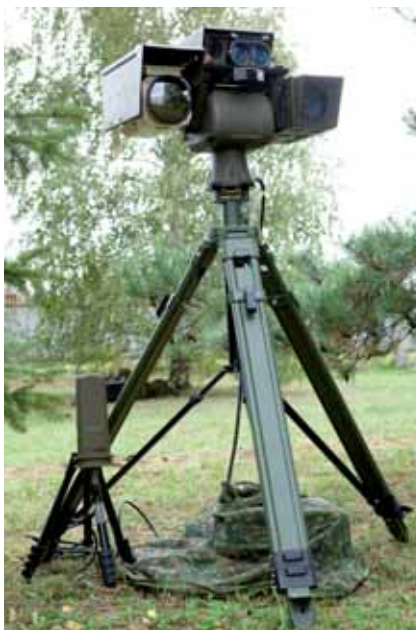
VÝNOSNÝ SYSTÉM DÁLKOVÉHO PRŮZKUMU (SDPz). VEDLE NĚJ NA MALÉ TROJNOŽCE JE ZAŘÍZENÍ PRO BEZDRÁTOVÝ PŘENOS OBRAZU MEZI SDPz A VOZIDLEM.
