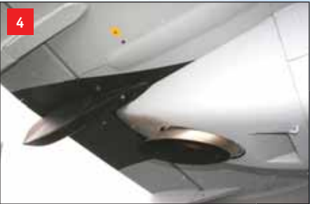
Zadní část gondoly motoru s tryskou turbovrtulového motoru, po stranách jsou kryty táhel klapek.
