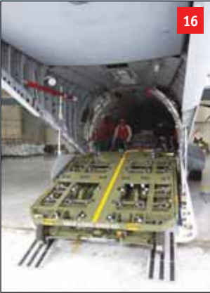
Na sklopné záďové rampě lze přepravovat teleskopickou nakládací plošinu s vlastním pohonem. Nahoře je vidět zdvižený spodek zádi trupu zvětšující prostor pro manipulaci s materiálem.
