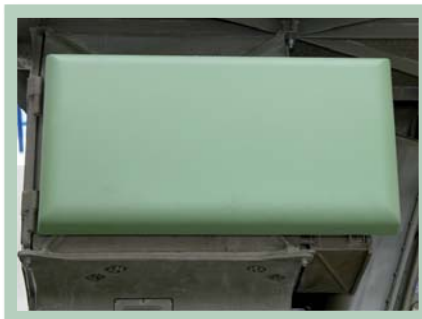
Anténa identifikačního systému IFF
