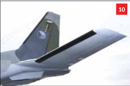
Svislá a vodorovná ocasní plocha osazená na odtokových hranách vybíječi statické elektriny a vířiče na spodku záďe trupu
