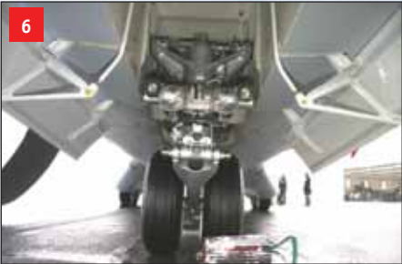
Přední podvozková noha se dvěma koly a dvěma reflektory
