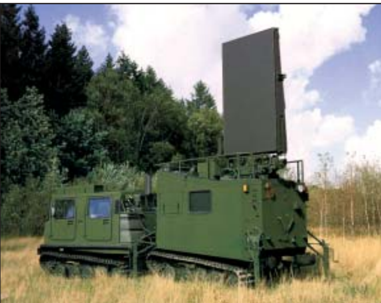
Nejvíce uživatelů si za nosič systému ARTHUR vybralo švédské obojživelné terénní vozidlo Bv206. Systém lze přepravovat nejen v letounu C-130, ale i v podvěsu pod vrtulníkem CH-47 CHINOOK.
