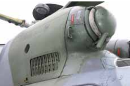
Přední část pravého motoru s filtrem
