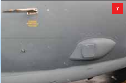
Boční část příďe trupu s pitotovou trubicí pro měření rychlosti letu vlevo a krytem senzorů vpravo
