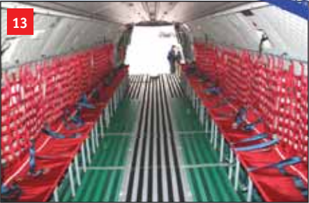
Nákladní prostor se dvěma řadami sklopných a demontovatelných plátěných sedaček pro 49 vystrojených vojáků
