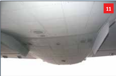
Spodní část konce trupu s vířiči stabilizujícími obtékání trupu a krytkami prostoru pro bloky dipólů
