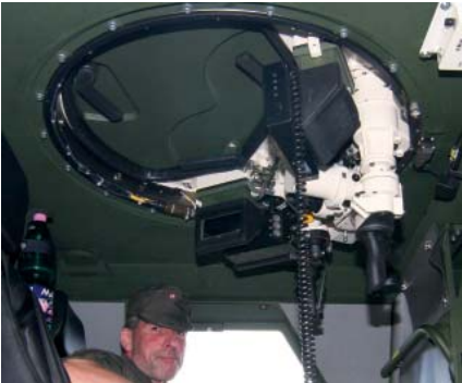
Dálkové ovládání zbraňové základny rakouského Dinga 2 zvenku a zevnitř (snímek vpravo)
