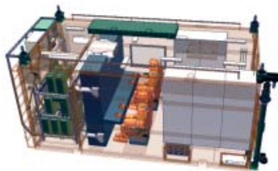
Systém ASVŘP je umístěn na jediném vozidle Tatra 815 4 x 4. Kresba ukazuje vnitřní uspořádání skříňového kontejneru místa bojového velení.
