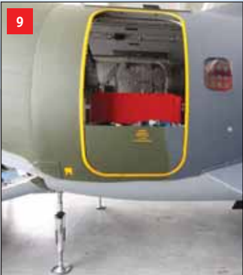
Příčně dělené pravé zadní dveře. Vlevo dole pod trupem jsou teleskopické opěry eliminující sednutí letounu při posunu těžkých nákladů po rampě. Další opěry zajišťují křídla a rampu ve vodorovné poloze.
