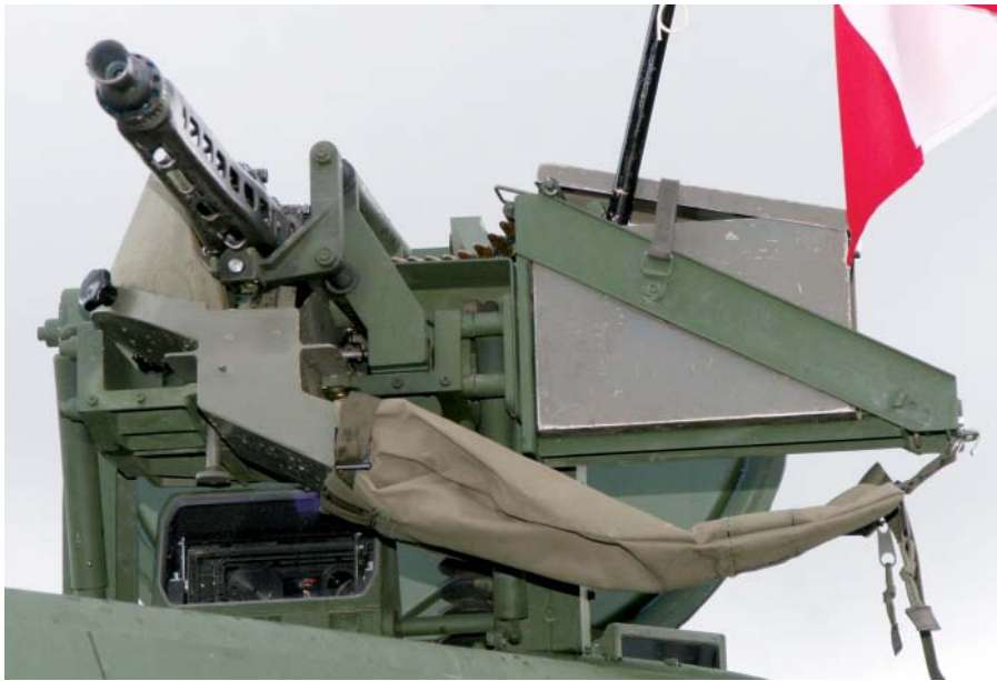
Dálkové ovládání zbraňové základny rakouského Dinga 2 zvenku a zevnitř (snímek vpravo)
