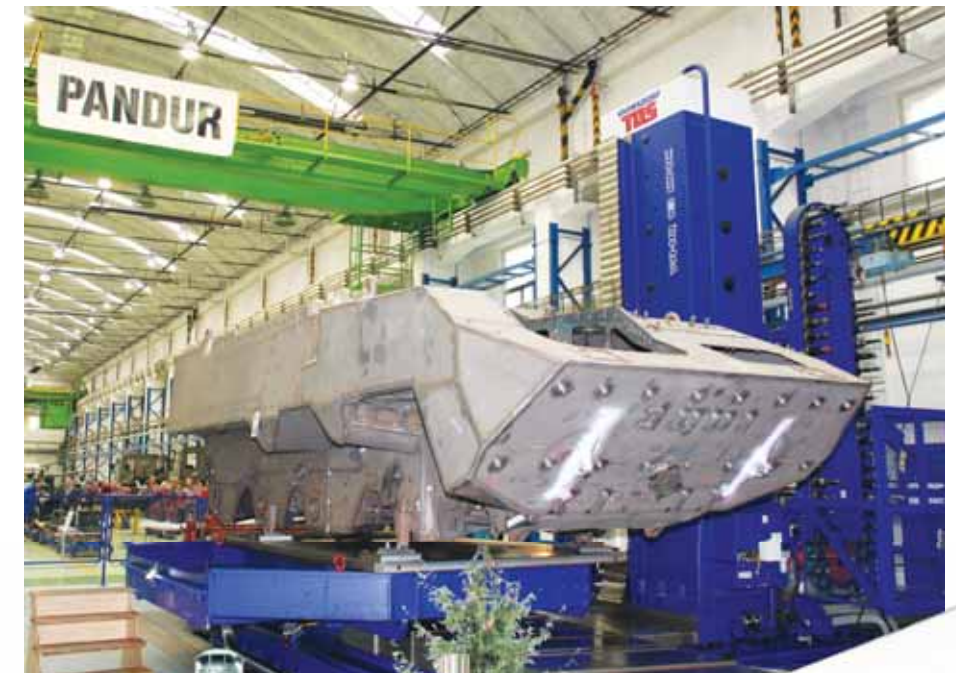
Pancéřová korba panduru na otočné svářecí a temperovací stolici
