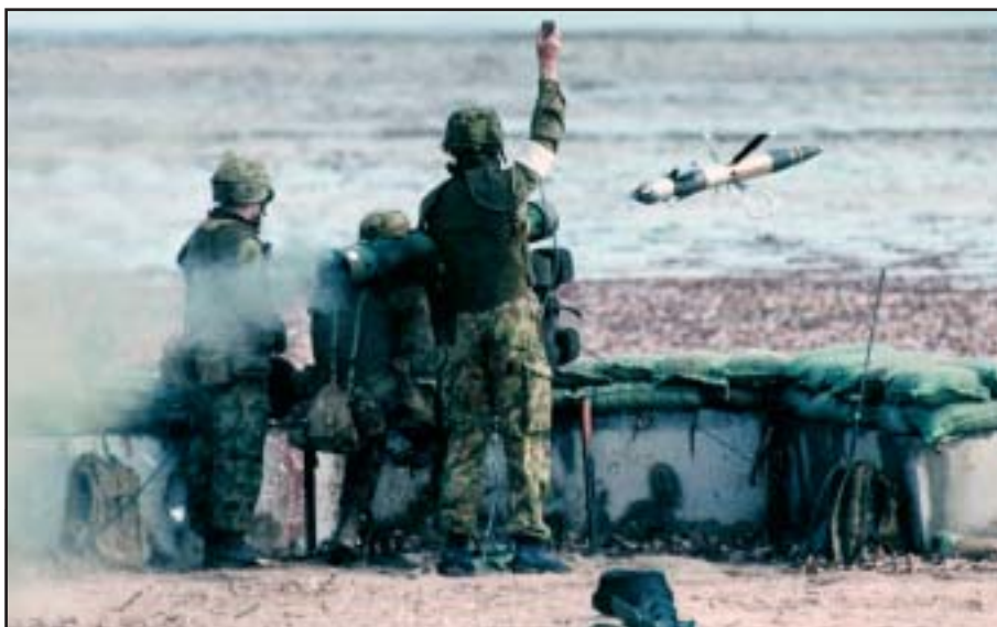
Okamžik odpálení za pomoci výmetné náplně na zádi. Ta záhy odpadne a v bezpečné vzdálenosti od střelce se zažehne letový motor, který raketě udělí dvojnásobnou rychlost zhouku.
