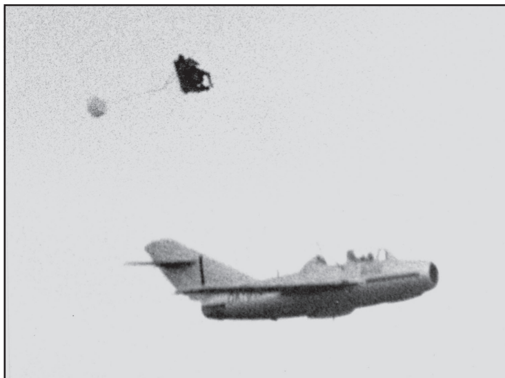
Zkušební katapultáž vystřelovacího sedadla z MiG-15UTI (archiv SL)
