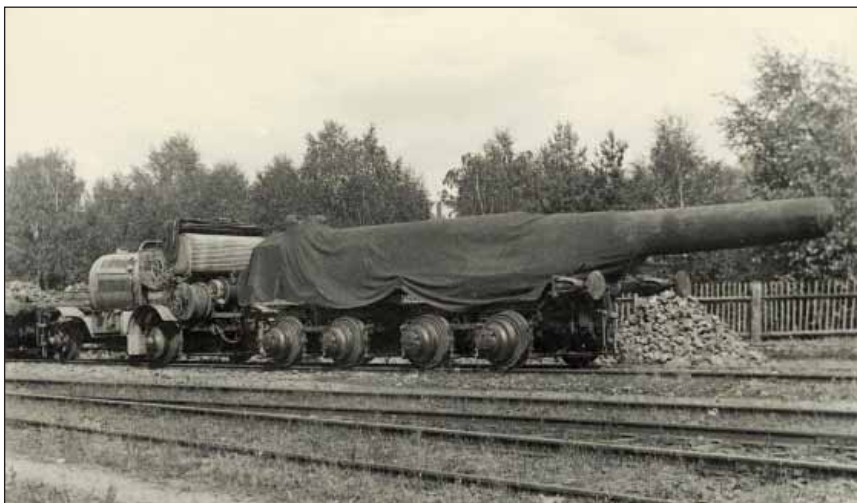
Benzinoelektrický vlak s hlavnovým vozem 24cm těžkého kanónu vz. 16, zde v úpravě pro železniční trakci
