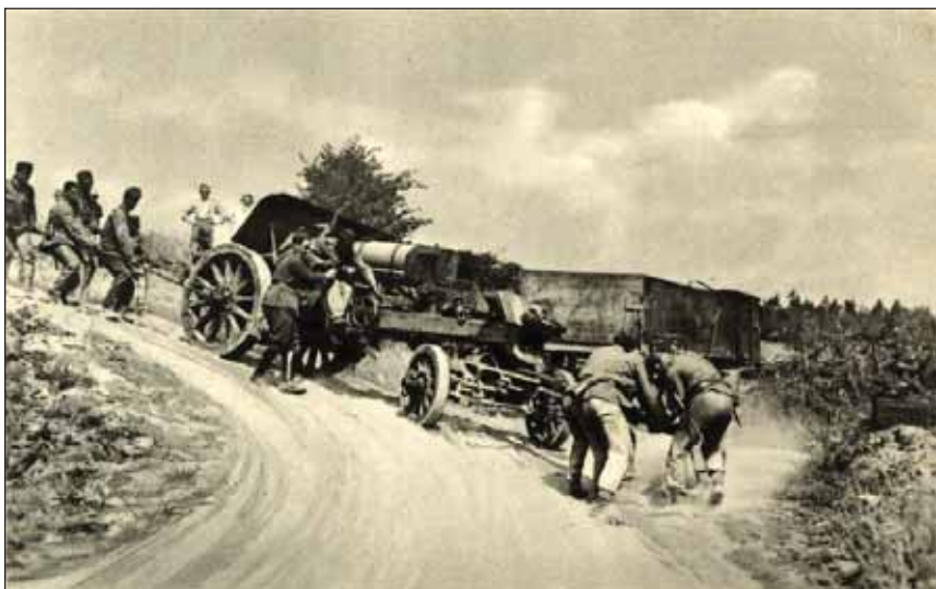
Dynamická manipulace s 15cm těžkou houfnicí vz. 15 po odpojení od tažného vozidla, ale ještě před zájezdem do palebného postavení
