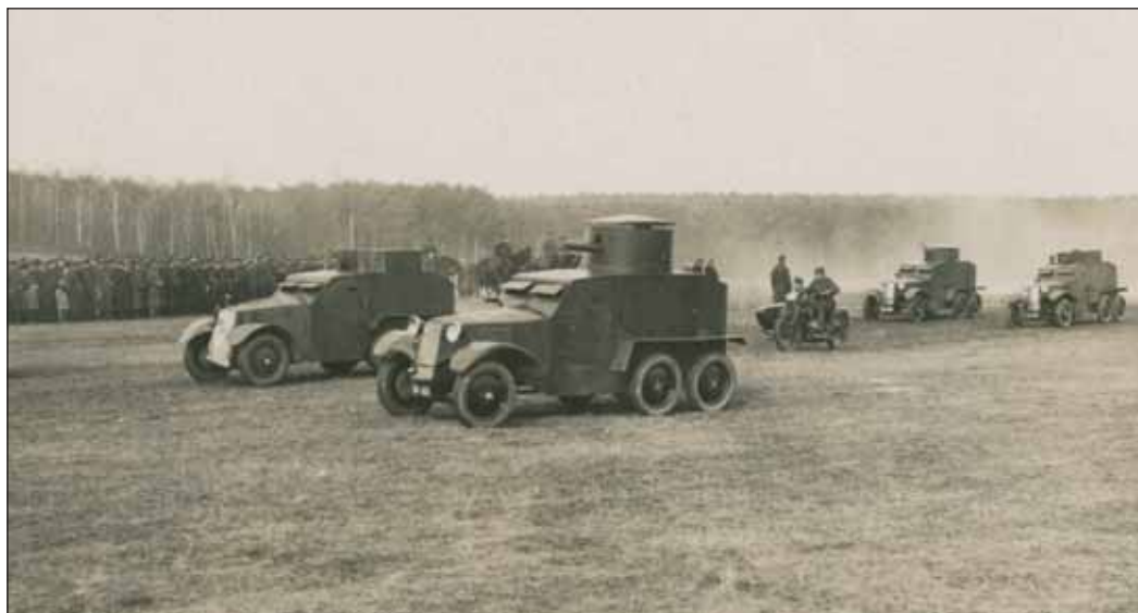
Vpředu defiluje obrněný automobil Tatra 26. V pozadí Tatra 26/30, které jsou opatřeny provizorními dřevěnými karoseriemi.
