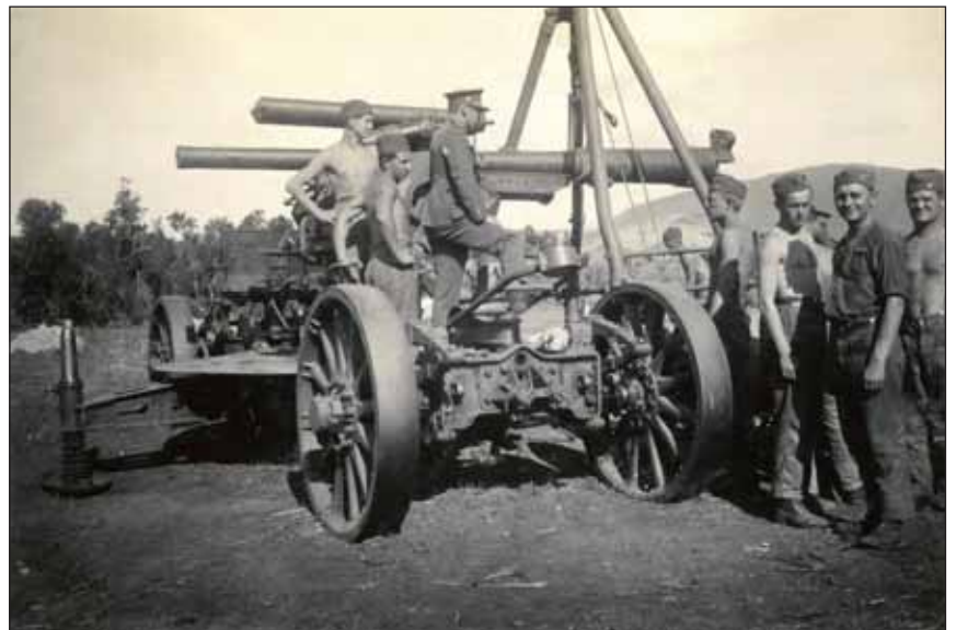
Výměna hlavní 8,35cm kanónu proti letadlům vz. 22
