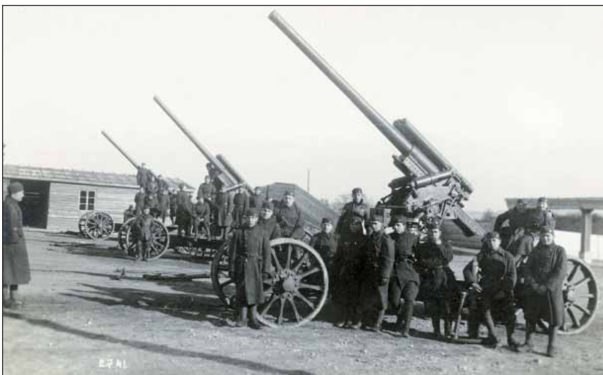
Standardní výzbroj dělostřelectva proti letadlům tvořily dlouhá léta 8,35cm kanóny proti letadlům vz. 22.
