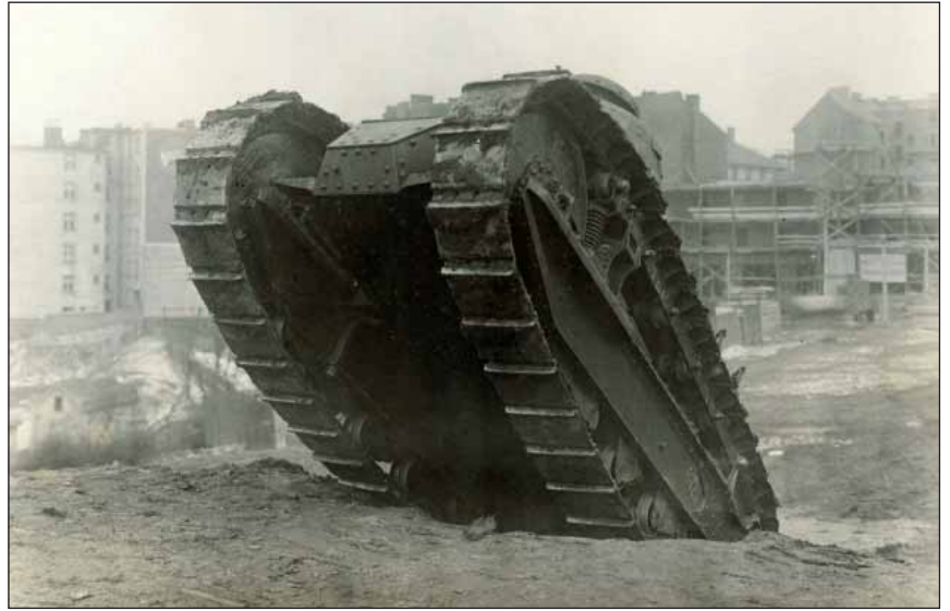
Robustní čelní část korby a masivní pásy lehkého tanku Renault FT
