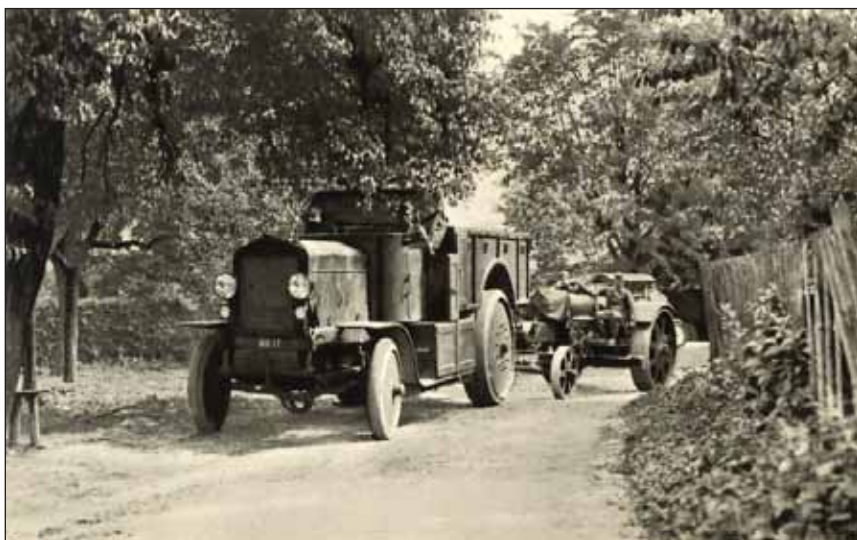
Tahač vz. 20 Z se zapřaženou 15cm těžkou houfnicí vz. 15
