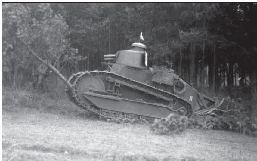
Závěrečná cvičení v prostoru Poličky, září 1923. Zkouška průchodnosti terémem dělového lehkého tanku FT-17. Praporek na věži označuje vůz velitele čety.
