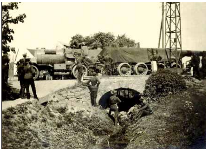
Benzinoelektrický vlak s hlavňovým vozem 24cm těžkého kanónu vz. 16 opatrně překonává letitý kamenný můstek.
