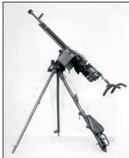
Pro palbu na nízko letící cíle byl určen protiletadlový kulomet ráže 12,7 mm
