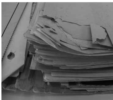
Ohnuté a poškozené rohy bloku.
