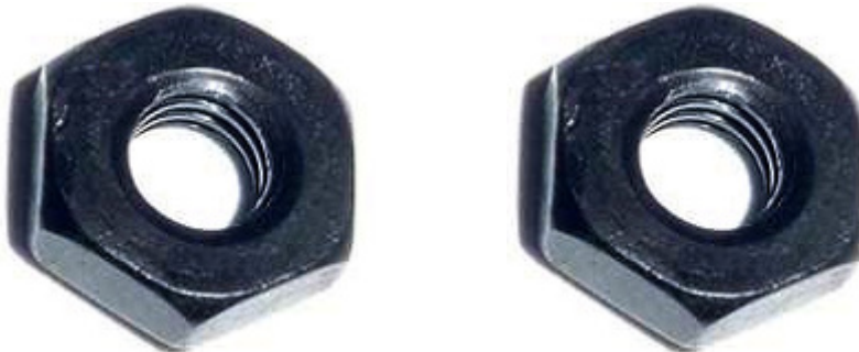
Matičky s vnitřní prasklinou
