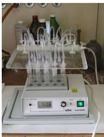
Obr.29: Odpařování org. extraktů ve vyhříváném termobloku pod proudem dusíku
