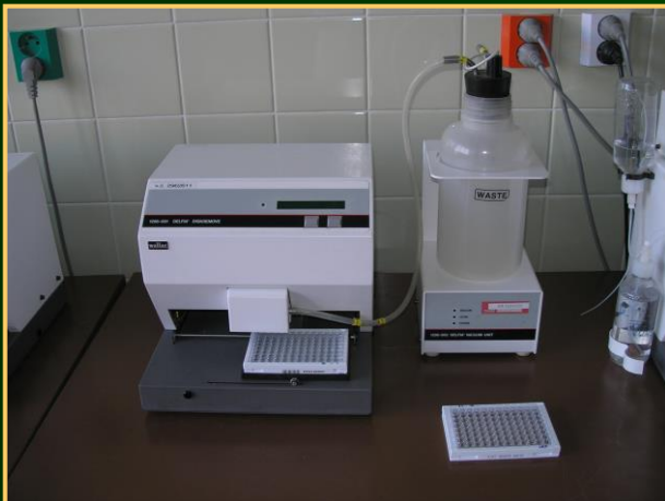
4 Odstranění terčů z jamek (vakuová odsávačka)
