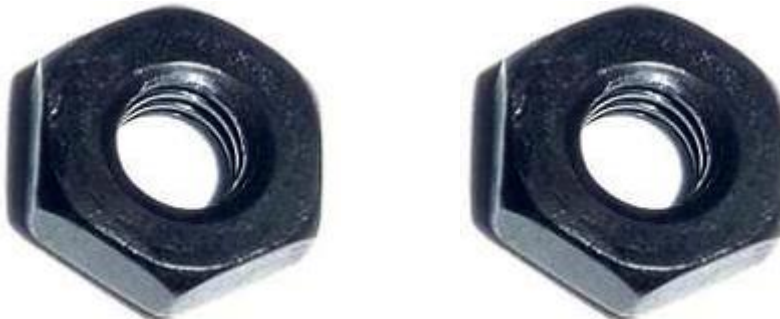
Matičky s vnitřní prasklinou
