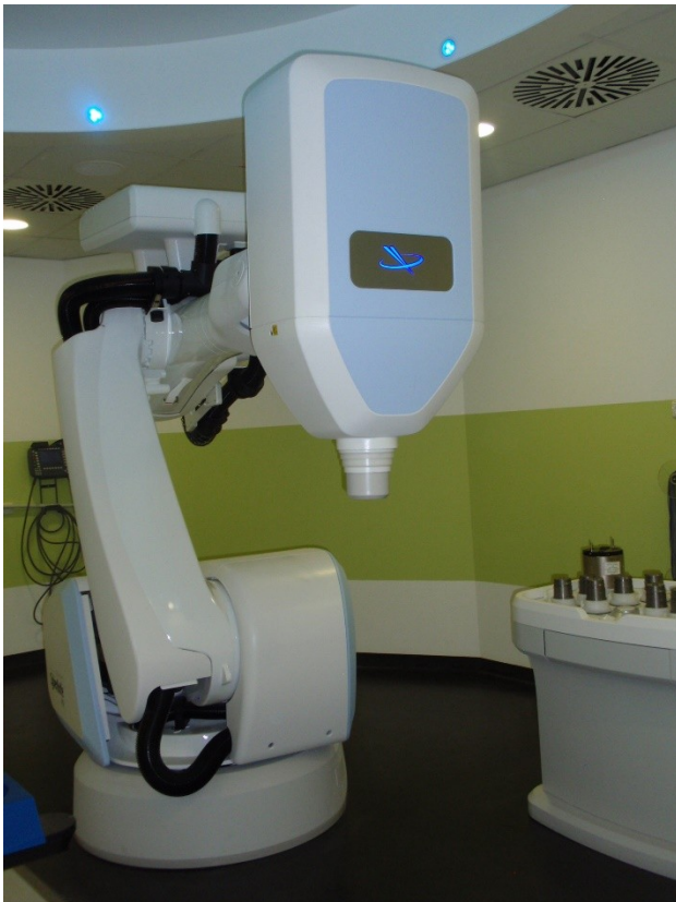
Obr. 6: CyberKnife – robotický ozařovač
