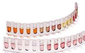
Měřicí kyvety analyzátorů Dade Behring Dimension ®
