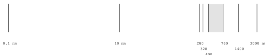
Obrázek .2 Rozsah vlnových délek záření s vyznačením (šedě) oblasti viditelného světla
