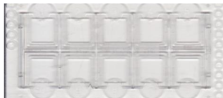
Fast Red 100: 10 komůrek pro manuální mikroskopii močového sedimentu na jedné platformě (vlevo fotografie, vpravo náčrt)
