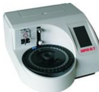
Další z „klasických“ analyzátorů glukózy Super GL2 firmy Dr. Müller, s enzymovou elektrodou (enzym součástí elektrodové membrány).
