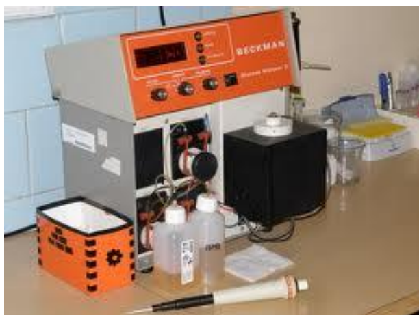
Klasický analyzátor glukózy firmy Beckman s Clarkovou elektrodou, enzym přítomný v roztoku (srovnej s popisem na str. 7-3). Vzorkem je sérum nebo plazma.
