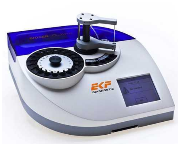
Analyzátor glukózy Biosen C-Line Clinic firmy EKF s biosenzorem (čipem, biočipem, v podstatě enzymovou elektrodou). Vzorkem je hemolyzát plné krve. Může obsahovat i senzor na stanovení laktátu. Srovnej též s popisem na str. 7- 3.
