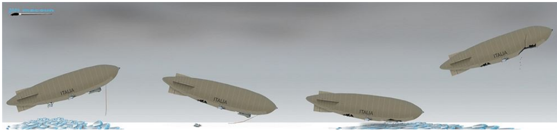
Obrázek 3.3.1 Průběh dopadu vzducholodi Italia na led a odtržení kabiny
