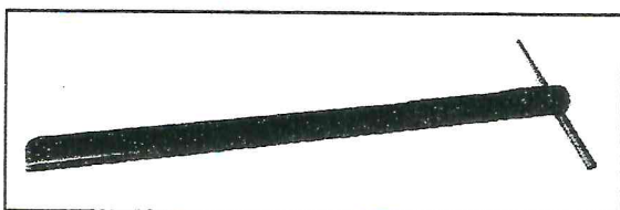
Obr. 1: Vzorkovač na pevné a pastovité materiály.
