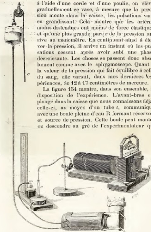
Fig. 153. — Disposition de l'expérience pour insérer la pression dans les vaisseaux de la main
