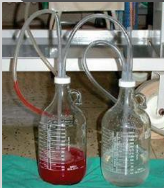
Obr. 1 – Resterilizovatelný systém skleněných lahví – dvoulahvový systém
