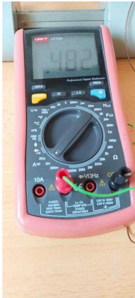
multimetr měřící fotoproud na fotodiodě
