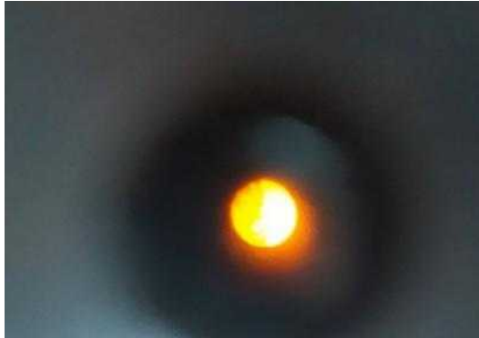
světelné pole před vyrovnáním (odlišný osvit v levém a pravém půlkruhu)
