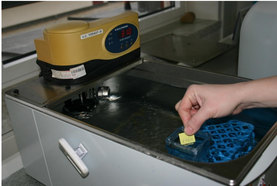
1 - inkubace preparátu v roztoku enzymu trypsinu (natrávení proteinů na povrchu chromosomů)
