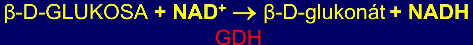
spektrofotometricky -vzrůst absorbance NADH při 340nm
