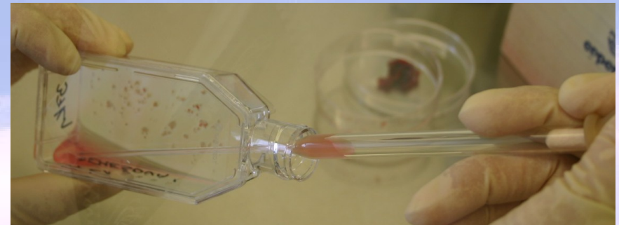
Odsátí přebytečného média (jen ovlhčené dno)
