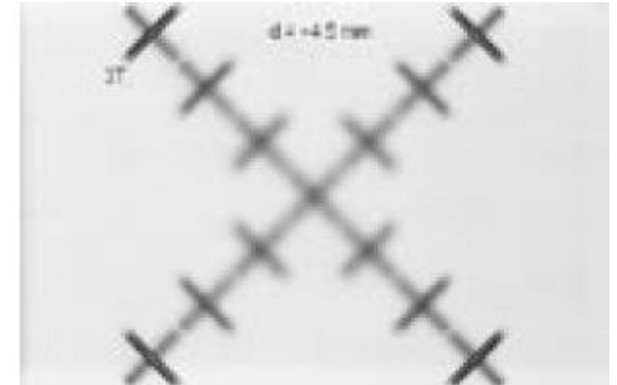
d = -4,5 mm (od ohniska k čočce) centrální část rozostřena, zaostřeny 3T čáry
