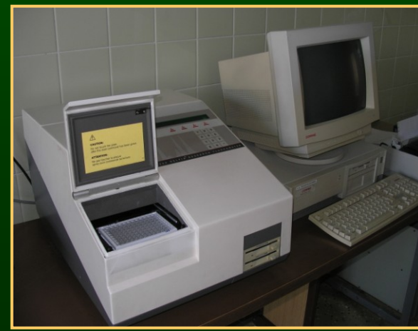
6 Měření na fluorometru po přidání zesilovacího roztoku
