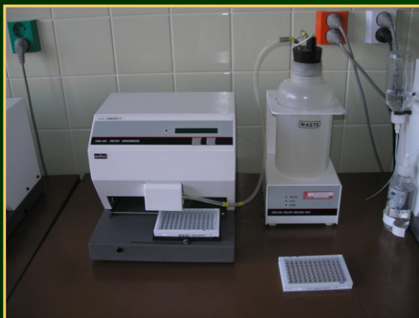
4 Odstranění terčků z jamek (vakuová odsávačka)
