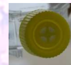
speciální uzávěr kultivačních nádobek s bakteriálním filtrem – propouští CO 2
