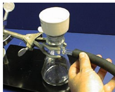
Zapojení odsávací baňky s Buchnerovou nálevkou na vakuum
