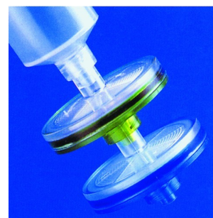
Sériové napojení dvou jednorázových filtrů se stříkačkou
