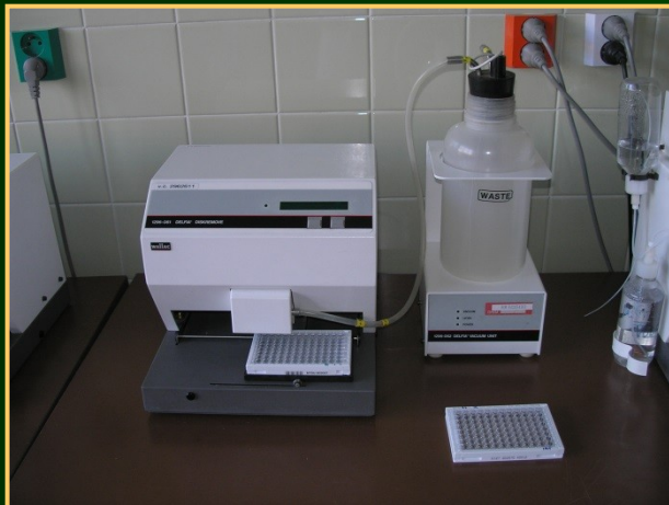
4 Odstranění terčů z jamek (vakuová odsávačka)
