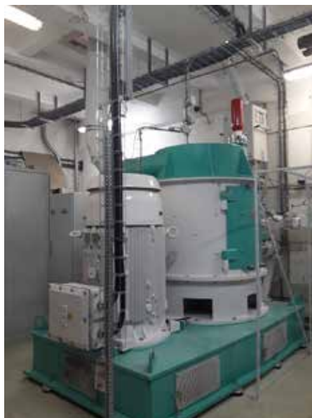
Obrázek 2: Speciální úderový mlýn pro výrobu jemných celozrnných mouk se sníženým glykemickým indexem
