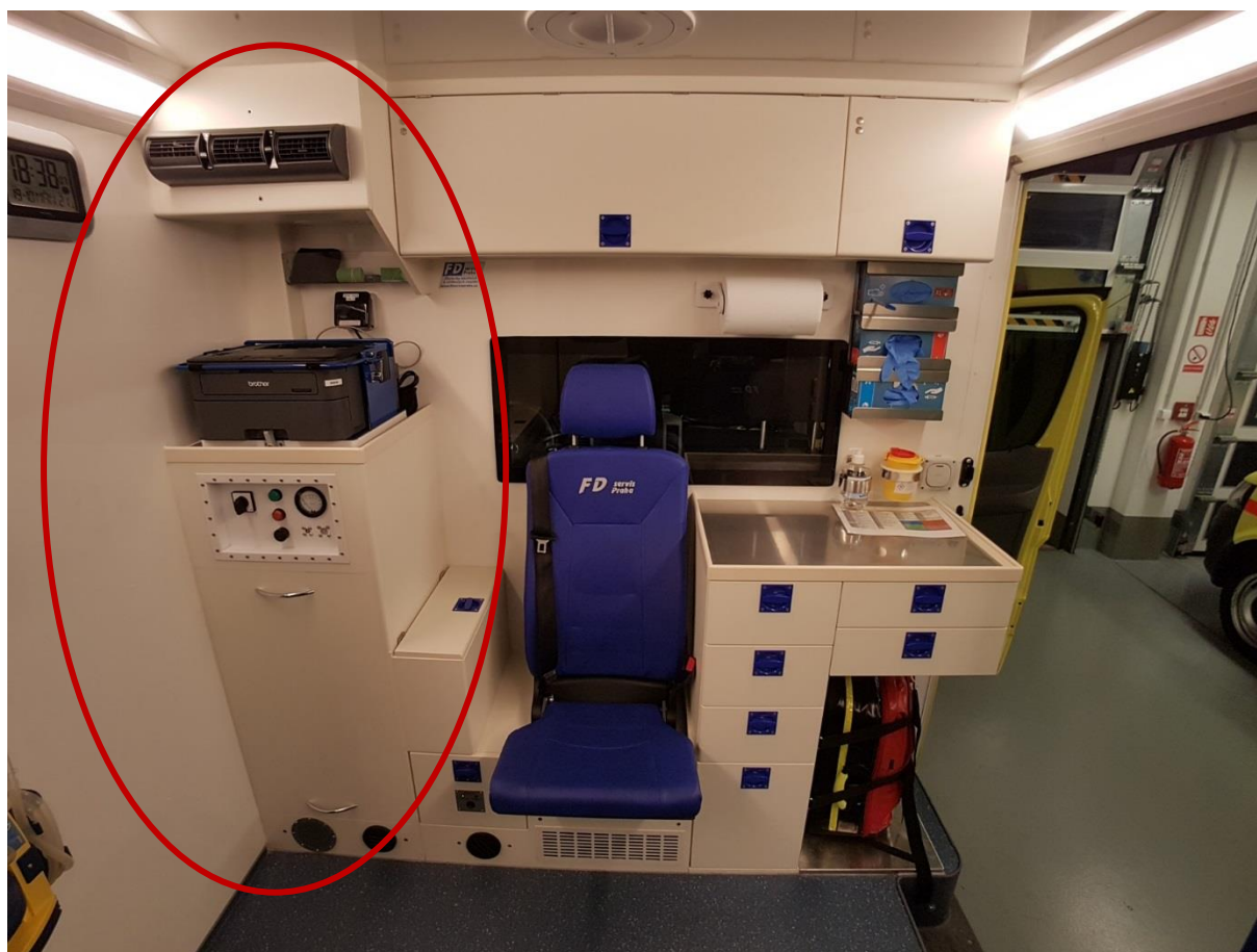
Obrázek 17 Filtrační jednotka ve vozu ZZS
