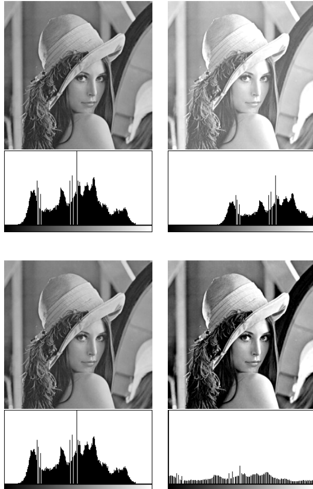
Obrázek 3.1: Horní dvojice snímků demonstruje zvýšení jasu prostým přičtením konstanty ke stupni jasu. Na histogramu je patrné, že je pouze posunut doleva, hodnoty, které by byly vyšší než je jas bílého bodu, jsou oříznuty a zobrazeny jako bílý bod. Na dolní dvojici snímků je demonstrováno zvýšení kontrastu vynásobením konstantou. protože by se tím histogram posunul na vyšší hodnoty, je současně vhodná konstanta odečtena. I zde bylo nutné ořezat nejvyšší a nejnižší hodnoty.
