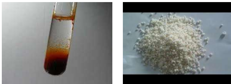
orientační zkouška přítomnosti bílkovin podle Nesslera
