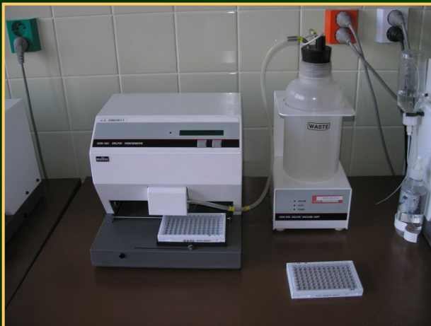
4 Odstranění terčků z jamek (vakuová odsávačka)
