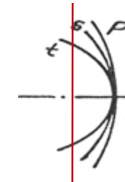
d = -4,5 \text{ mm} (od ohniska k čočce) centrální část rozostřena, zaostřeny 3T čáry
