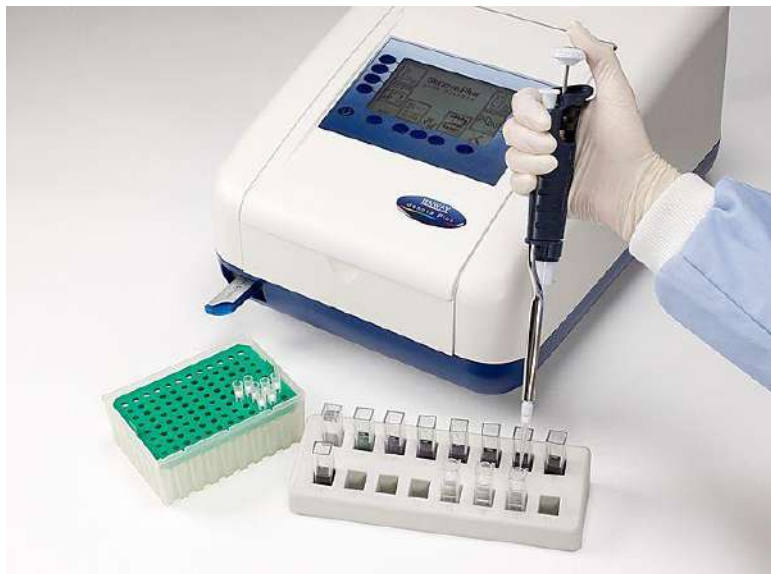
spektrofotometrické stanovení po reakci s Nesslerovým činidlem
