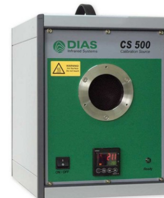
Kalibrační tzv. černé těleso
