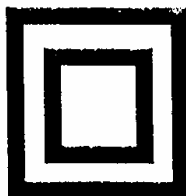
Obr.7 Symbol pro elektrická zařízení třídy ochrany II
