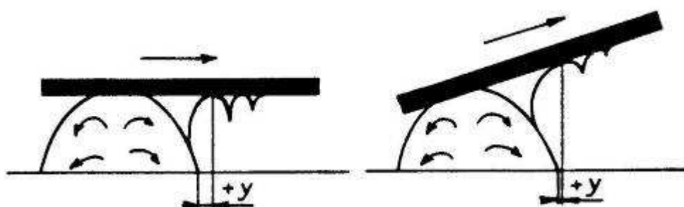
Obr. 7.161 Princip vzniku krápníků a jejich potlačení náklonem
